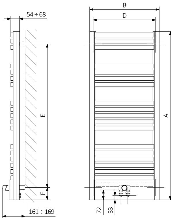
A – Höhe B – Breite C1-C5 – Anschlussabstand D – horizontaler Wandhalterungsabstand E – Vertikaler Wandhalterungsabstand F – Abstand von der Achse der unteren Wandhalterung bis Unterkante des Kollektors
